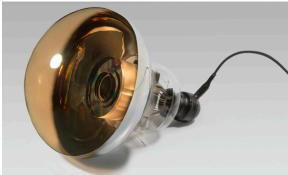
図 2.3: ID に設置された直径約 50cm の光電子増倍管 [6]
