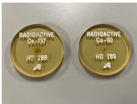
図 8: エネルギー較正に用いた放射線源 (左) ^{137}\text{Cs} (右) ^{60}\text{Co}
