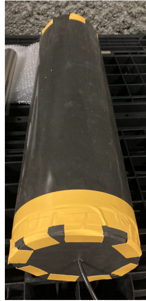
(c) Setup B: 外観 (ボロンシートで被覆後)
