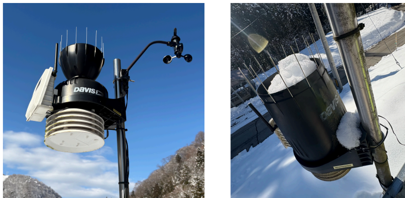
図 49: KAGRA 雨量計の外観（左）と、冬季に融雪が追いつかず雪が堆積している例（右） 冬季データ除外（12/16–3/15）の根拠となる。
