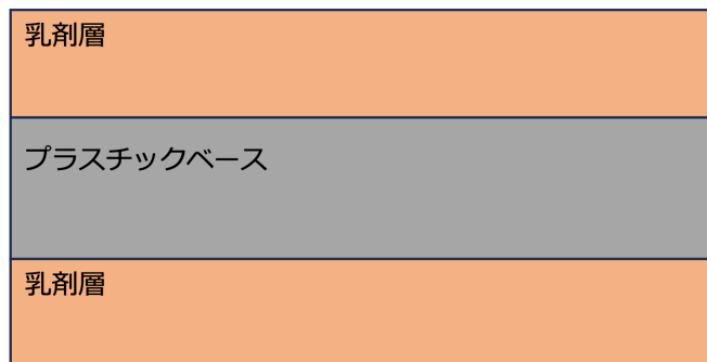
図 6: 原子核乾板の構造
